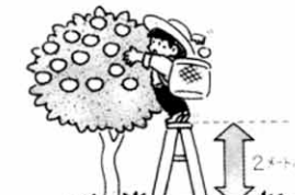
(ロ) 高さが2メートル以上の箇所における作業
