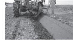
写真4 畦塗機による補修
